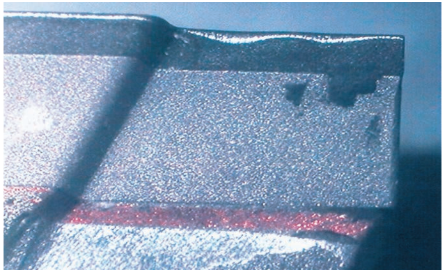
Schneidkantenverrundung nach Einsatz in GFK.
