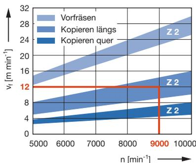
Vorschubgeschwindigkeit  $v_f$  in Abhängigkeit von Zähnezahl Z und Drehzahl n für Vollhölzer (Vorräsen und Kopieren).
