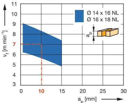
**Werkstückstoff:** Duromere, Schichtstoffe (HPL, CPL), Kunststoffe faserverstärkt
