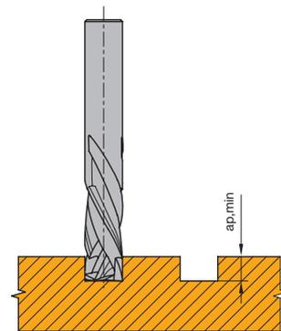
Minimale Nuttiefe  $a_{p \min}$  für ausrissfreien Schnitt
