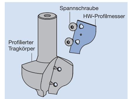
Die Profilierung der Messer, Stützplatten und Tragkörper erfolgt in der nächstgelegenen Leitz Servicestelle.
