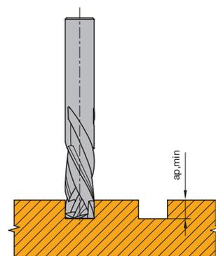
Minimale Nuttiefe  $a_{p\ min}$  für ausrissfreien Schnitt
