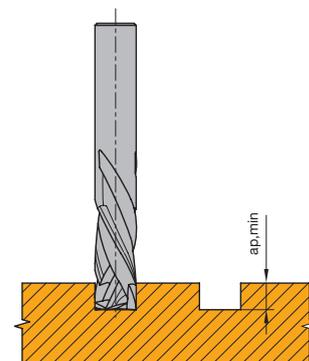
Minimale Nutttiefe  $a_{p \min}$  für ausrissfreien Schnitt
