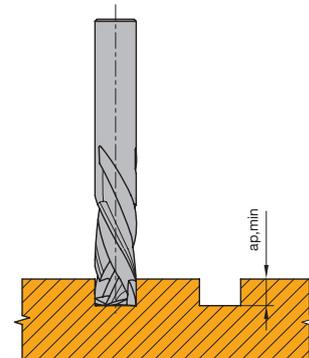
Minimale Nuttiefe  $a_{p \text{ min}}$  für ausrissfreien Schnitt
