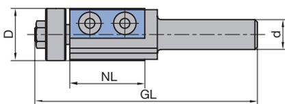
Wendeplatten-Bündigfräser mit Anlauftring unten
