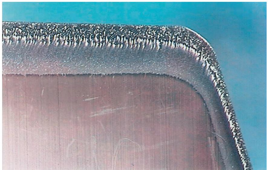
Chemischer Einfluss – Schneidkantenverrundung – Einsatz in Eiche.
