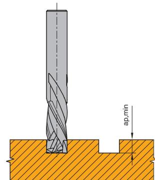
Minimale Nuttiefe  $a_{p, \min}$  für ausrissfreien Schnitt
