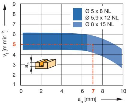
**Werkstückstoff:** Duromere, Plastomere, Verbundwerkstoffe
