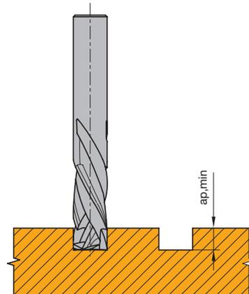
Minimale Nuttiefe  $a_{p,min}$  für ausrissfreien Schnitt
