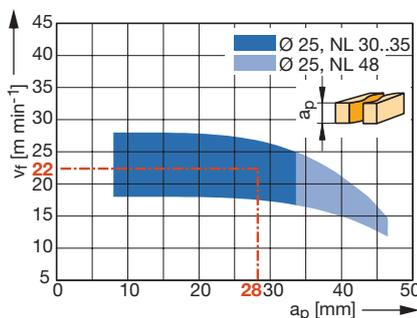
**Werkstückstoff:** Spanplatte kunststoffbeschichtet
