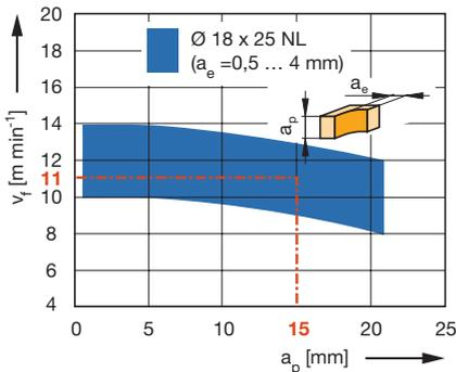
**Drehzahl:**  $n = 16000 - 24000 \text{ min}^{-1}$
