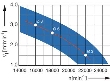
**Drehzahl:**  $n = 16000 - 22000 \text{ min}^{-1}$   $v_f = 2,0 - 2,5 \text{ m min}^{-1}$
