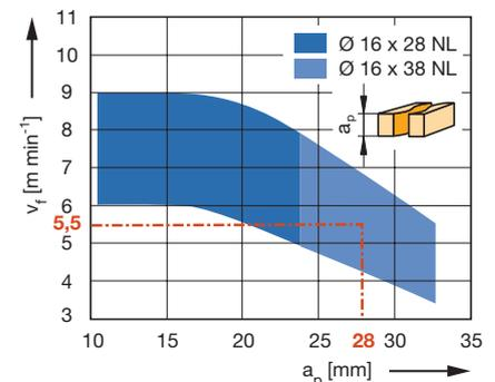
**Werkstückstoff:** Spanplatte kunststoffbeschichtet
