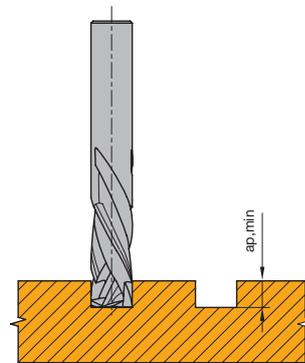
Minimale Nutttiefe  $a_{p \min}$  für ausrissfreien Schnitt
