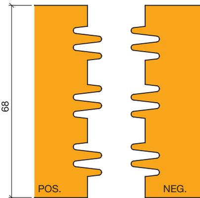
Verleimprofil positiv und negativ in einem Werkzeug kombiniert
