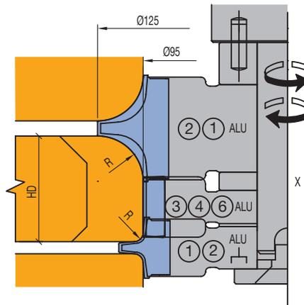
Bei Klemmhöhe 75mm ist keine Kombination mit Werkzeug ② und ② bzw. ⑤ und ⑦ möglich.
