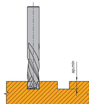
Minimale Nutttiefe  $a_{p \min}$  für ausrissfreien Schnitt
