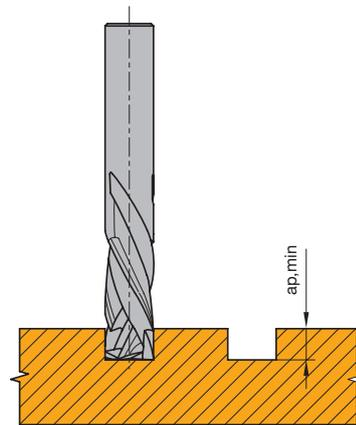
Minimale Nuttiefe  $a_{p \min}$  für ausrissfreien Schnitt
