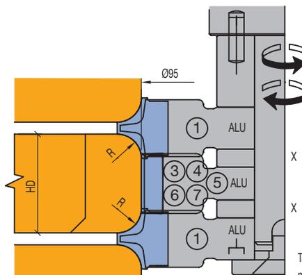
Bei Klemmhöhe 75mm ist keine Kombination mit Werkzeug ② möglich.
