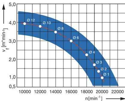
**Drehzahl:**  $n = 8000 - 24000 \text{ min}^{-1}$   $v_f = 1,0 - 4,0 \text{ m min}^{-1}$
