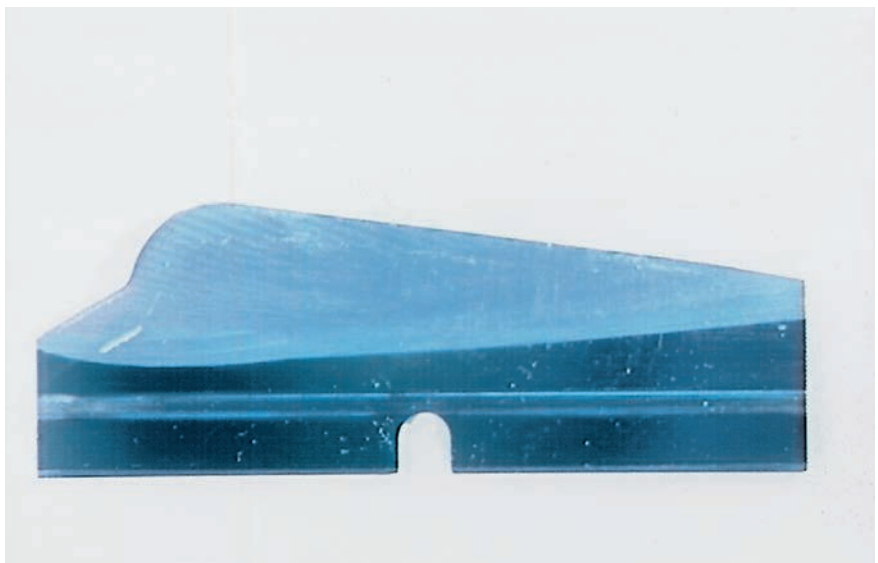
Usure de l'arête tranchante après une mauvaise maintenance.
